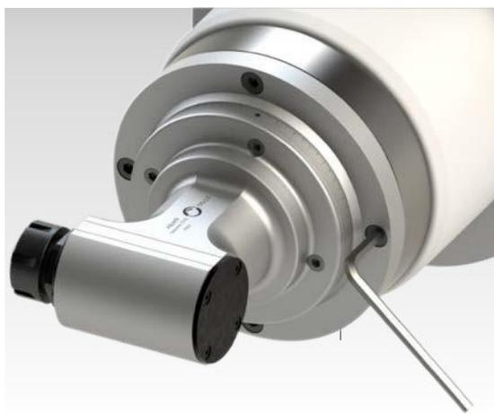
f) Rimontare la testa sull' anello appositamente realizzato e bloccare il tutto alla macchina con almeno 3 viti.
