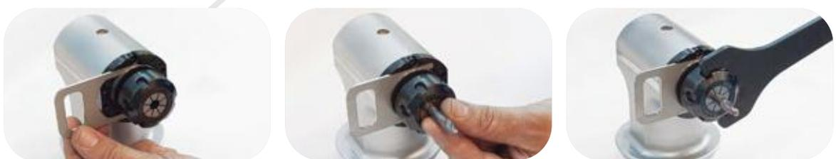
**Nuovo e pratico sistema che facilita l'operazione di serraggio utensile sfruttando una chiave di contrasto da inserire sull'albero in modo da avere una mano libera.**
