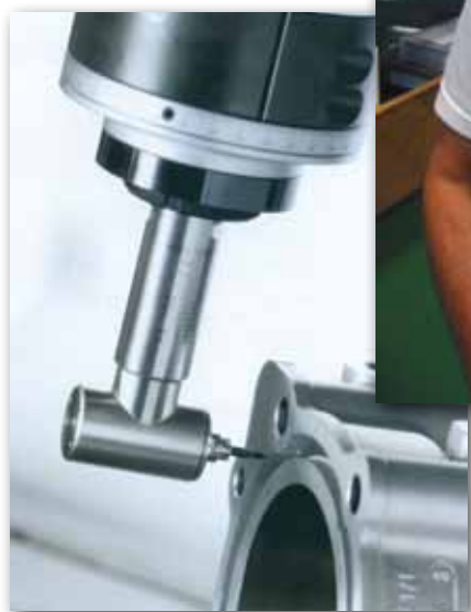
Umberto Alberti mostra un nuovo mandrino ad alta velocità con manipolo ad aria che, come evidenziato a lato, in più configurazioni si presta a lavorazioni di precisione in alta velocità
