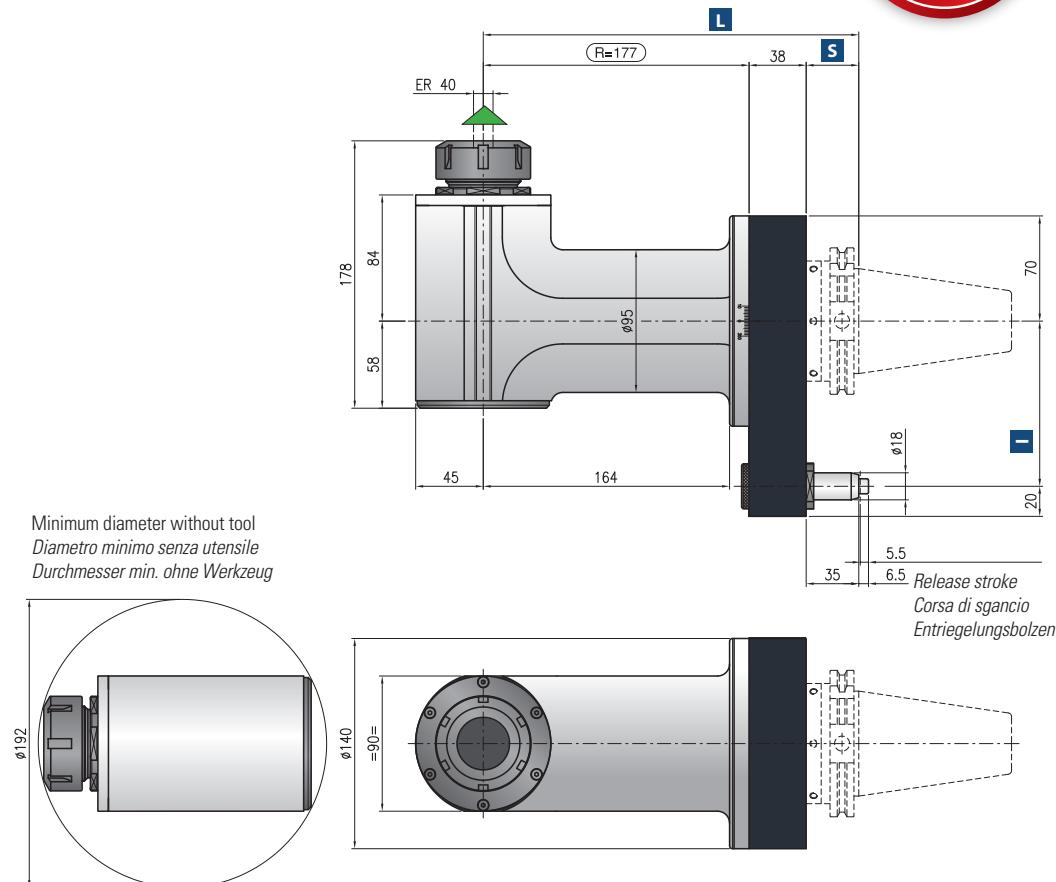
Possibilità refrigerante / Internal coolant / Innere Kühlmittelzuführ - Max. 12 bar
