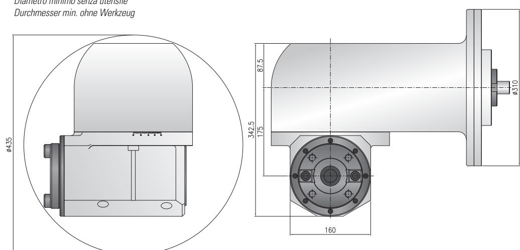
Direction of rotation same as to machine spindle / *senso di rotazione uguale al mandrino / Drehrichtung gleich wie Antriebsspindel*
