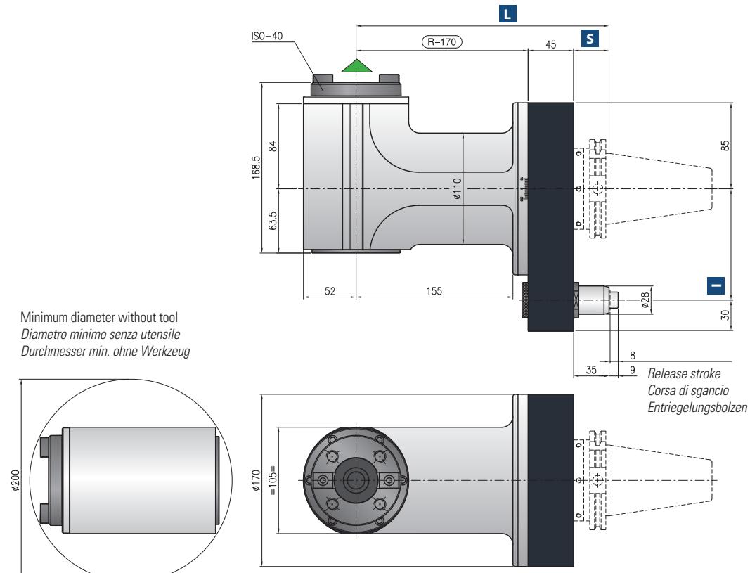
Possibilità refrigerante / Internal coolant / Innere Kühlmittelzuführ - Max. 12 bar
