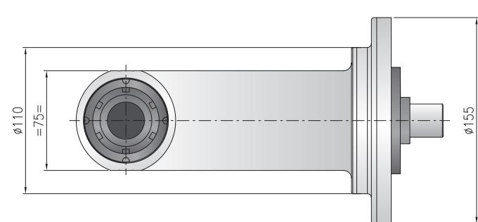
▲ Direction of rotation same as machine spindle / senso di rotazione uguale al mandrino / Drehrichtung gleich wie Antriebsspinde
