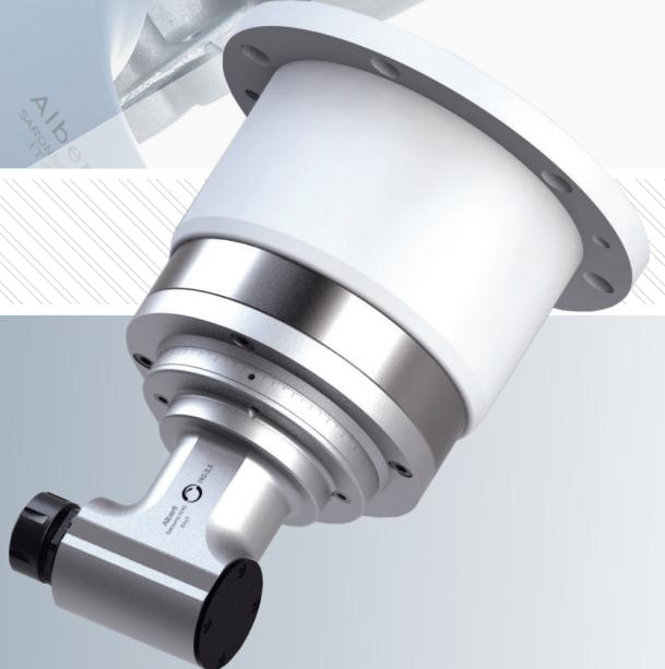
Le teste della linea MODULAR sono adatte ad essere montate su macchine utensili tradizionali da fissare al mandrino tramite apposita flangia. Sono dotate di un cono intercambiabile, una flangia universale e la possibilità di avere alcuni moduli di prolunga per variarne la lunghezza. Per un corretto montaggio, è necessario realizzare una flangia di adattamento da inserire tra la testa e il mandrino.
