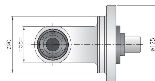
Direction of rotation same as machine spindle / senso di rotazione uguale al mandrino / Drehrichtung gleich wie Antriebsspinde
