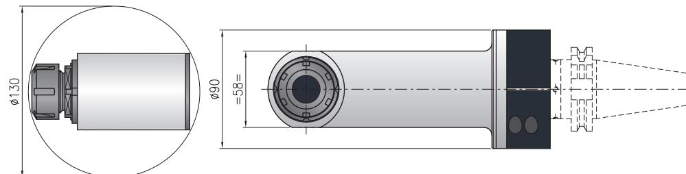
(water droplet icon) Possibilità refrigerante / Internal coolant / Innere Kühlmittelzuführ - Max. 40 bar
